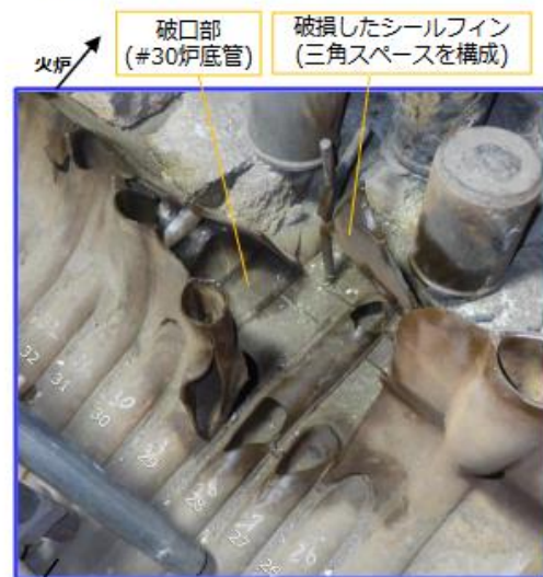
火炉～外部熱交間の非加熱空間 火炉炉底管状況 (起点と推定)
