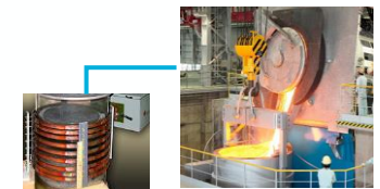
【誘導加熱式】※電気を使用
